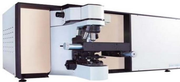
**Fig. 3.3** LabRAM HR micro-Raman instrument <sup>60</sup>
